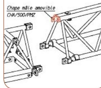
**PRINCIPE D'ASSEMBLAGE DES POUTRES ENTRE ELLES :**
